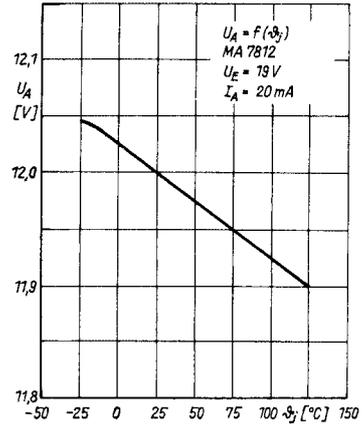
**Bild 3:** Ausgangsspannung eines MA 7812 als Funktion der Chiptemperatur
