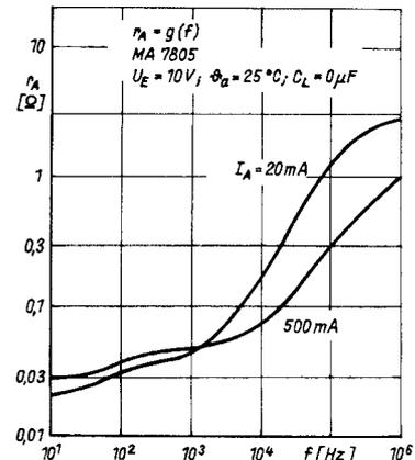
**Bild 6:** Frequenzabhängigkeit des Ausgangswiderstandes eines MA 7805
