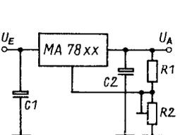
**Bild 11:** Erhöhung der Ausgangsspannung (o. r.)
