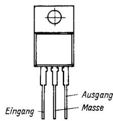
**Bild 9:** Gehäusevariante im TO-220-Gehäuse (nicht TESLA)
